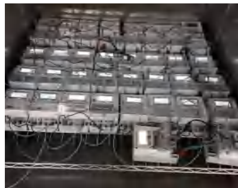
图3 电能表多因素故障激励检测
