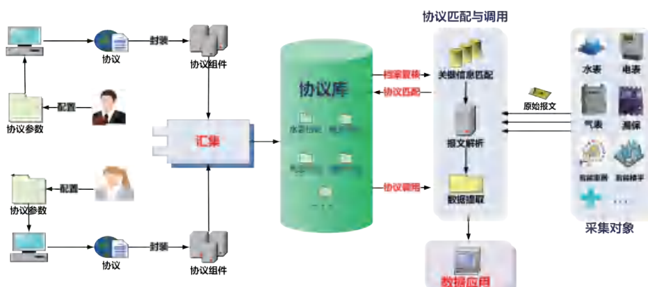
图2 组件化协议库架构
