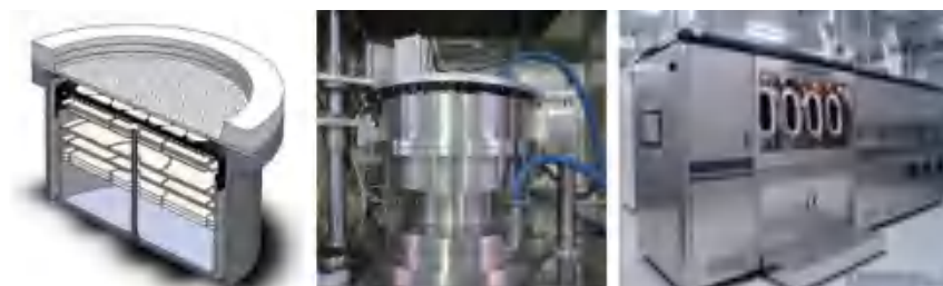
图2 新型37×2英寸化学气相沉积炉
