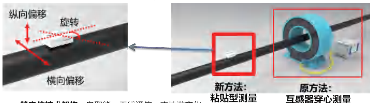
图1 基于磁电阻的等电位电流传感技术架构
