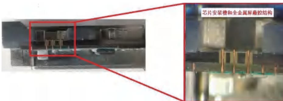
宽带微波组件芯片安装部位局部放大图
