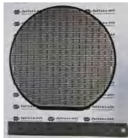
图 2 GaN 基异质结功率器件表界面态机理与调控 + 6 英寸 650V 超薄势垒 Si 基 GaN 增强型 MIS-HEMT
