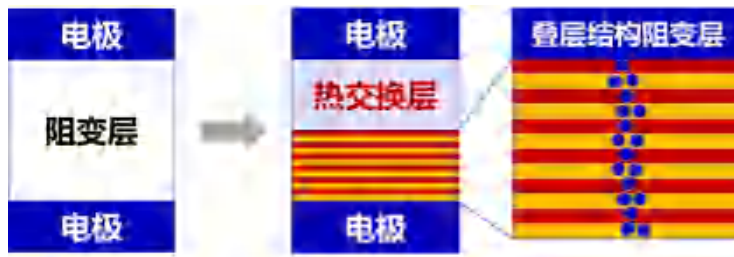
图 4 融合热交换层和叠层结构的存算一体忆阻器
