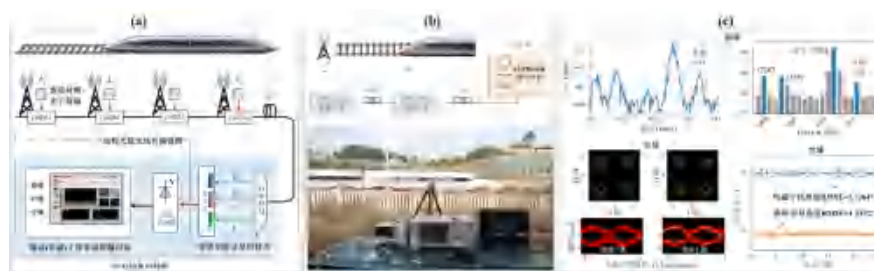
图 2 光纤远程分布式微波频谱与电磁干扰监测方法与结果： (a) 面向高铁的微波 / 电磁干扰监测系统； (b) 针对高铁专用车地无线通信的电磁干扰监测应用； (c) 高铁车地无线通信信号的频域 (频谱与授权频段号)、时域 (眼图与星座图)、空域 (到达方向) 监测与识别结果。
